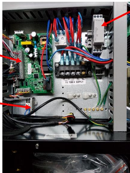
3 Phasen Relais bei 400V Maschine
