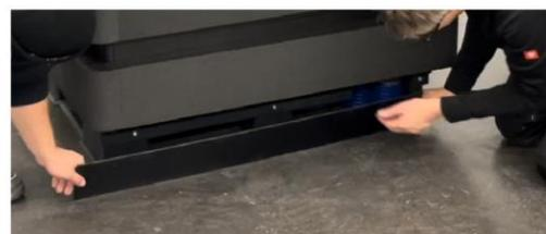
Abschließend befestigen Sie die Bodenblenden an den dafür vorgesehenen Gewinden an allen Vier Seiten der Grundplatte.
