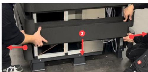
Verfahren Sie nun wie unter Schritt 1 und drücken Sie die vordere Paneele 2 nach unten während Sie die Seitenteile ● leicht nach außen drücken. Entnehmen Sie anschließend Paneele 2
