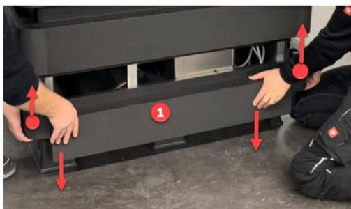
Stützen Sie mit leichtem Druck die seitlichen Dämmteile ● und drücken Sie die Vordere Dämmpaneele 1 vorsichtig nach unten.
