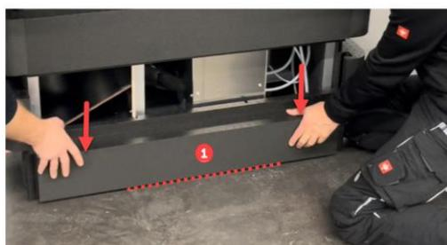
Drücken Sie die vordere Dämmpaneele 1 bis ganz nach unten um sie aus dem Verbund zu lösen
