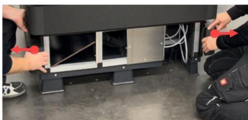
Um die nächste Paneele zu entnehmen müssen Sie zunächst die Seitenteile ● etwas nach außen drücken um Platz zu schaffen für das anschließende Entnehmen der folgenden Paneelen.
