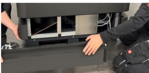
Entnehmen Sie die Dämmpaneele 1 und heben Sie diese an einem sicheren und sauberen Ort auf.
