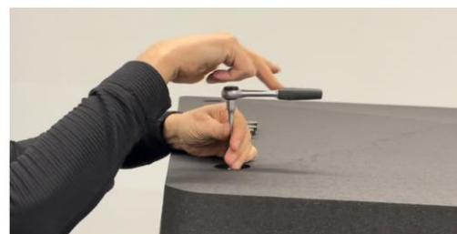
Wenn das Gehäuse wieder geschlossen ist, ziehen Sie die Muttern im Deckel (4st.) Handfest mittels eines Ratschenschlüssels und einer 10mm Sechskantnuss an. **Vorsicht: Zu starkes anziehen führt zum brechen der Kunststoffdämmung.**
