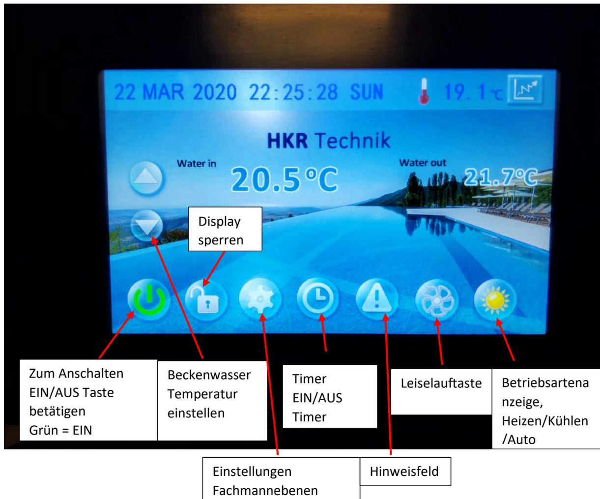
**Beim Einschalten kann das Display dunkel sein, zum Starten bitte kurz in den Bildschirm tippen. Das Display schaltet die Beleuchtung automatisch ab wenn es nicht benutzt wird.**
