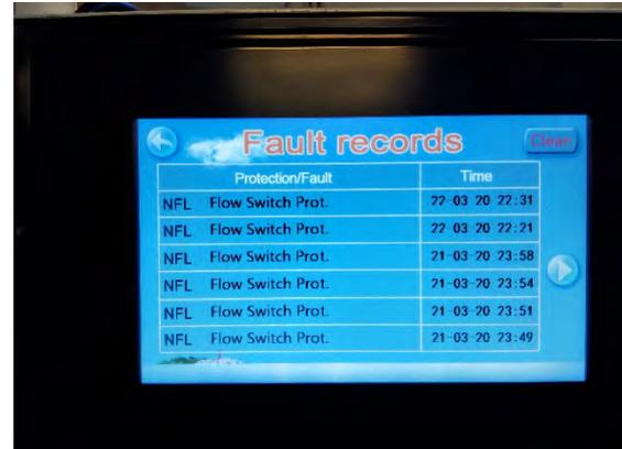
Im obigen Bild sehen Sie mögliche Fehler welche die Anlage ausgegeben hat. **NFL wie im aktuellen Bild ist kein Fehler!!** Siehe Erklärung in nächster Spalte
