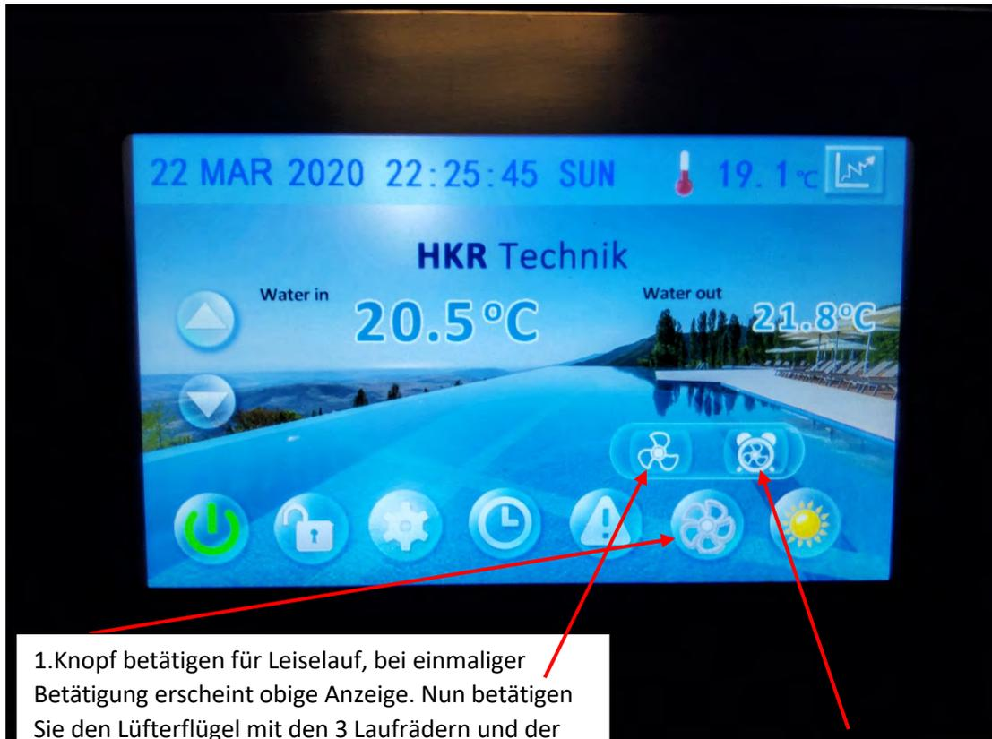
1. Knopf betätigen für Leiselauf, bei einmaliger Betätigung erscheint obige Anzeige. Nun betätigen Sie den Lüfterflügel mit den 3 Laufrädern und der manuelle Leiselauf ist für 12 Stunden gesetzt. Im Leiselauf reduziert sich die Leistung der Wärmepumpe und die Lautstärke. Nach 12 Stunden geht die Maschine in den automatischen Betriebszustand über, in welchem sich das Gerät automatisch auf die benötigte Leistung einstellt.
