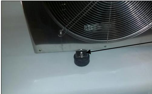
Beiliegende GummifüÙe anbringen, Maschine auf festen ebenen Untergrund stellen.
