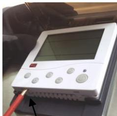
Display mit Schraubenzieher an den vorgesehenen Öffnungen eindrücken und aushebeln
